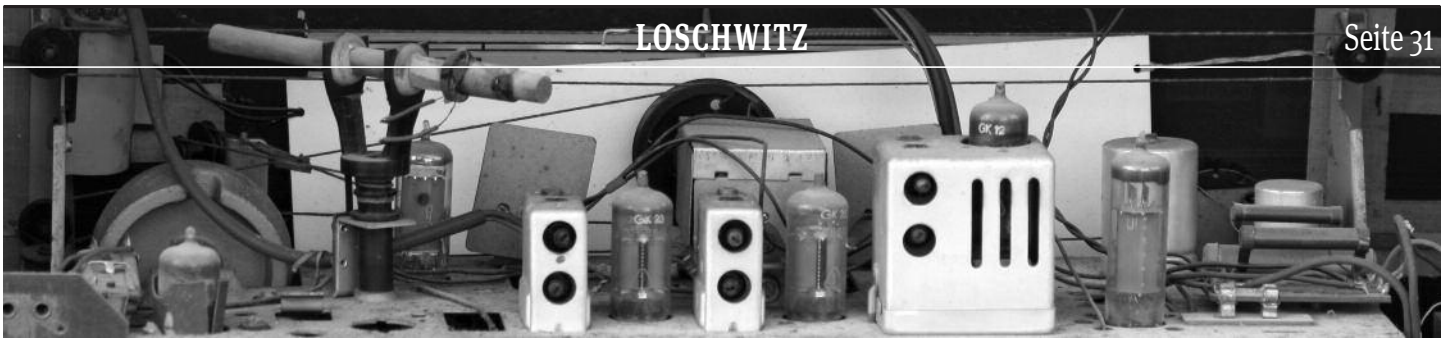
Innenleben des Radios »Dominante« mit drehbarer Ferrit-Antenne und Röhren, den Vorgängern der Transistoren
